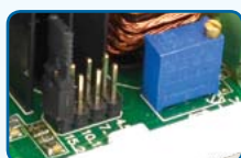
Regulacja napięcia - zworka - potencjometr
