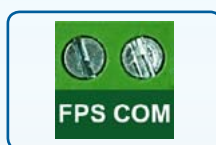
Wyjście techniczne typu OC FPS - awaria bezpiecznika
