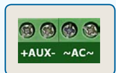
Zaciski wyjścia/wejścia zasilania
