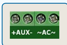
Zaciski wyjścia/wejścia zasilania
