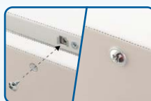
Zamykanie – skręcanie od czoła – 2 szt. / 4 szt.
