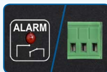
Wyjście techniczne ALARM przełącznik C/NO/NC
